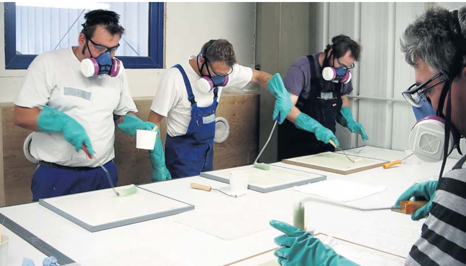
Teilnehmer eines Qualifizierungskurses beim Laminieren von Kunststoffplatten: Seit eineinhalb Jahren bietet Zeit & Service die Fortbildung zum Faserverbundkunststoff-Praktiker an. Künftig wird die Bildungsgesellschaft Schulungen im neuen Technologiezentrum vornehmen.
