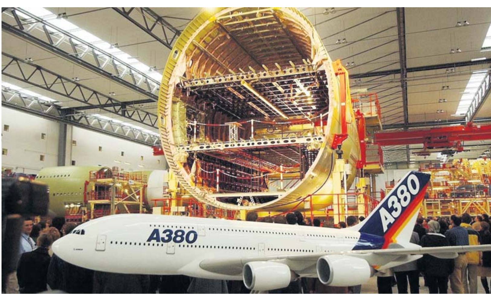
Die erste in Hamburg fertiggestellte Rumpfsktion für den Airbus A380 steht in der Halle hinter einem Modell des Riesenjets (Archivfoto). Das japanische Unternehmen Jamco, das sich auch im Technologiezentrum Nordenham engagiert, fertigt die Querträger der Oberdecks aus CFK. Foto: dpa
