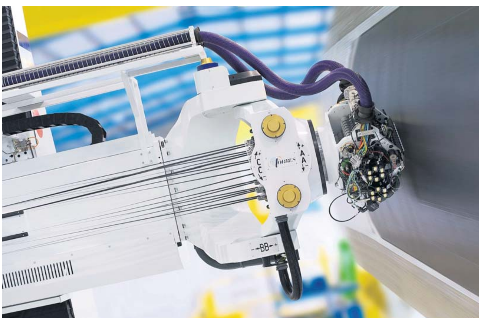
Blick auf den Legekopf einer Fibre-Placement-Anlage von M. Torres: Die Maschine legt viele schmale Kohlenstoffasern nebeneinander auf eine Ablegeform. Mit dieser Technologie können auch runde Bauteile – wie eine Flugzeugrumpfschale – aus CFK-Material hergestellt werden. Foto: M.Torres
