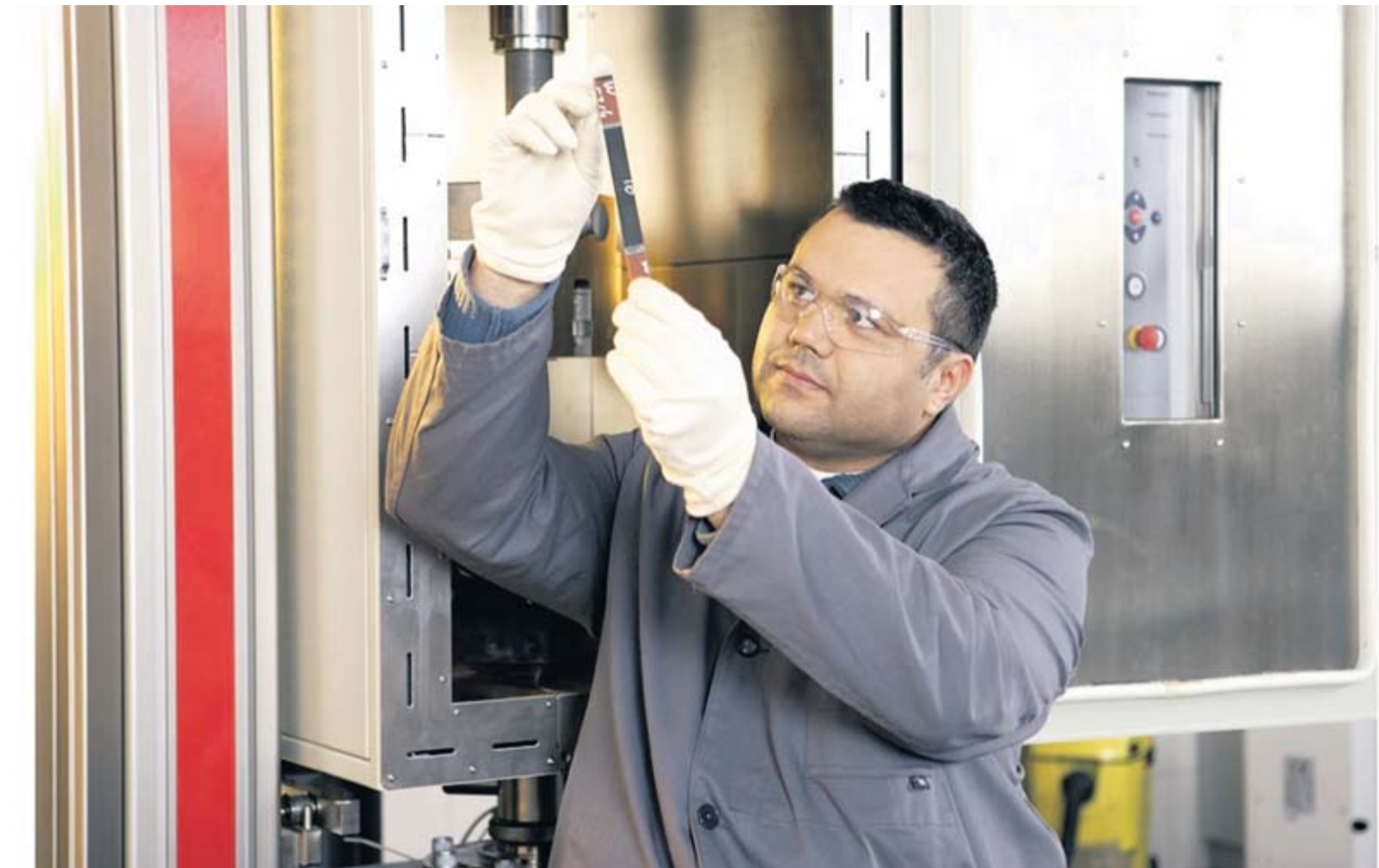
Ein GMA-Mitarbeiter untersucht eine CFK-Probe. Sogenannte zerstörende Prüfungen geben Auskunft über die Werkstoffeigenschaften. Foto: GMA
