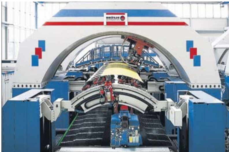
In der Rumpfschalenfertigung des Nordenhamer Flugzeugwerks kommen zahlreiche Nietanlagen von Brötje-Automation zum Einsatz. Foto: pr
