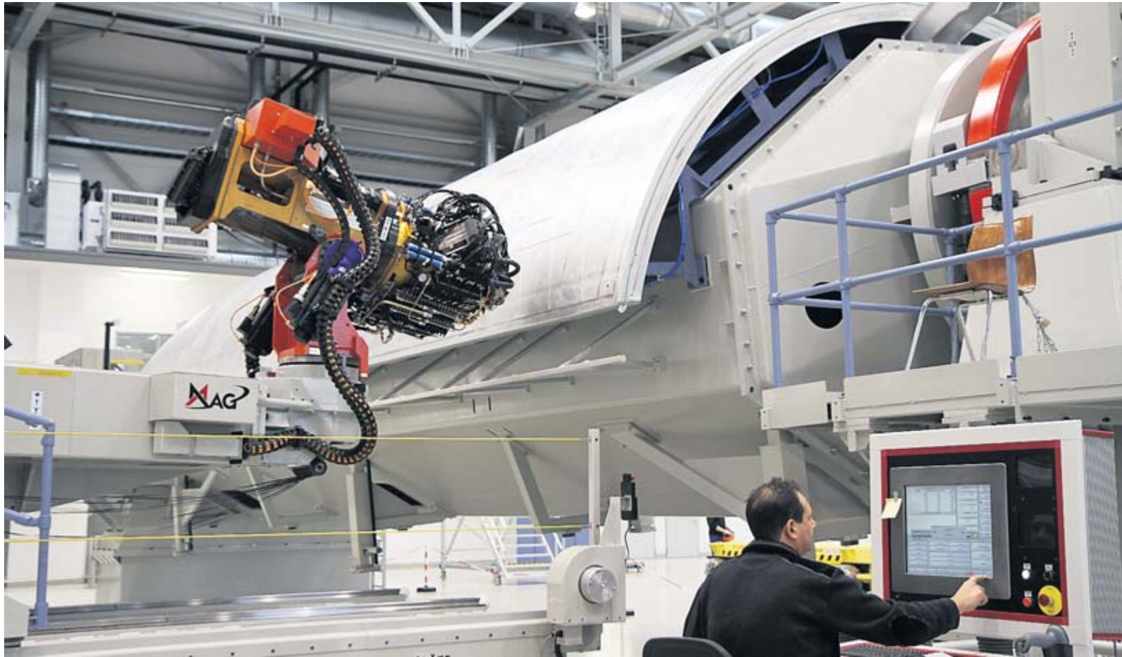
Premium Aerotec setzt in Einswarden eine CFK-Faserlegemaschine von MAG ein. Ein Projekt im TZN soll zu mehr Produktivität führen.
