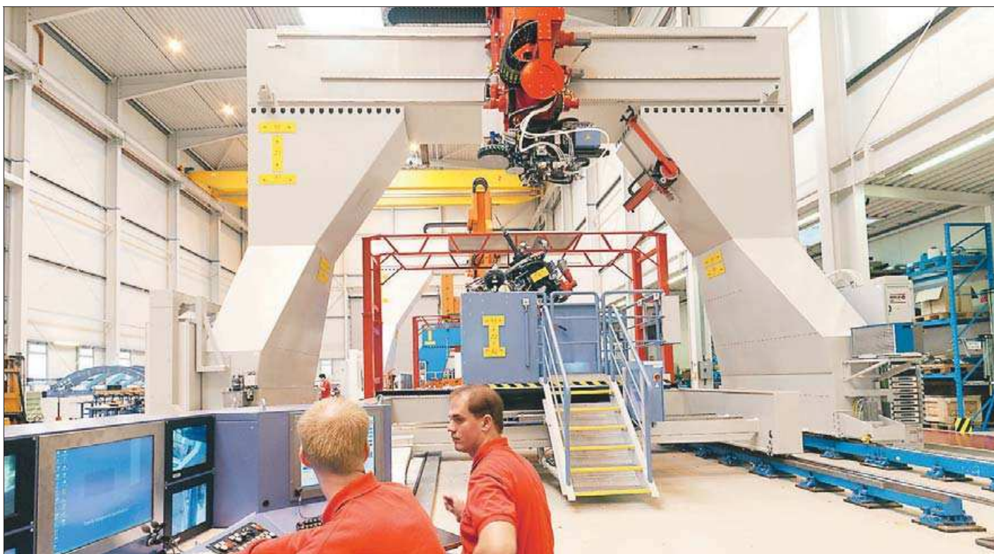
In der Werkserprobung: Brötje-Automation Multi Panel Assembly Cell (MPAC), eine Anlage für die automatische Montage von Bauteilen aus kohlestofffaserverstärkten Kunststoffen (CFK).
