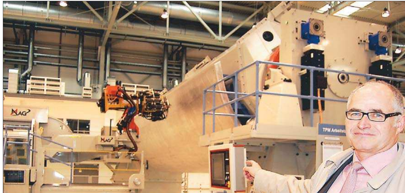
Premium Aerotec-Fertigungsleiter Matthias Spengler zeigt auf die Legemaschine der Firma MAG. Es handelt sich um das Herzstück der Teilefertigung für die A 350 in den drei in Einswarden neu errichteten Werkshallen.
