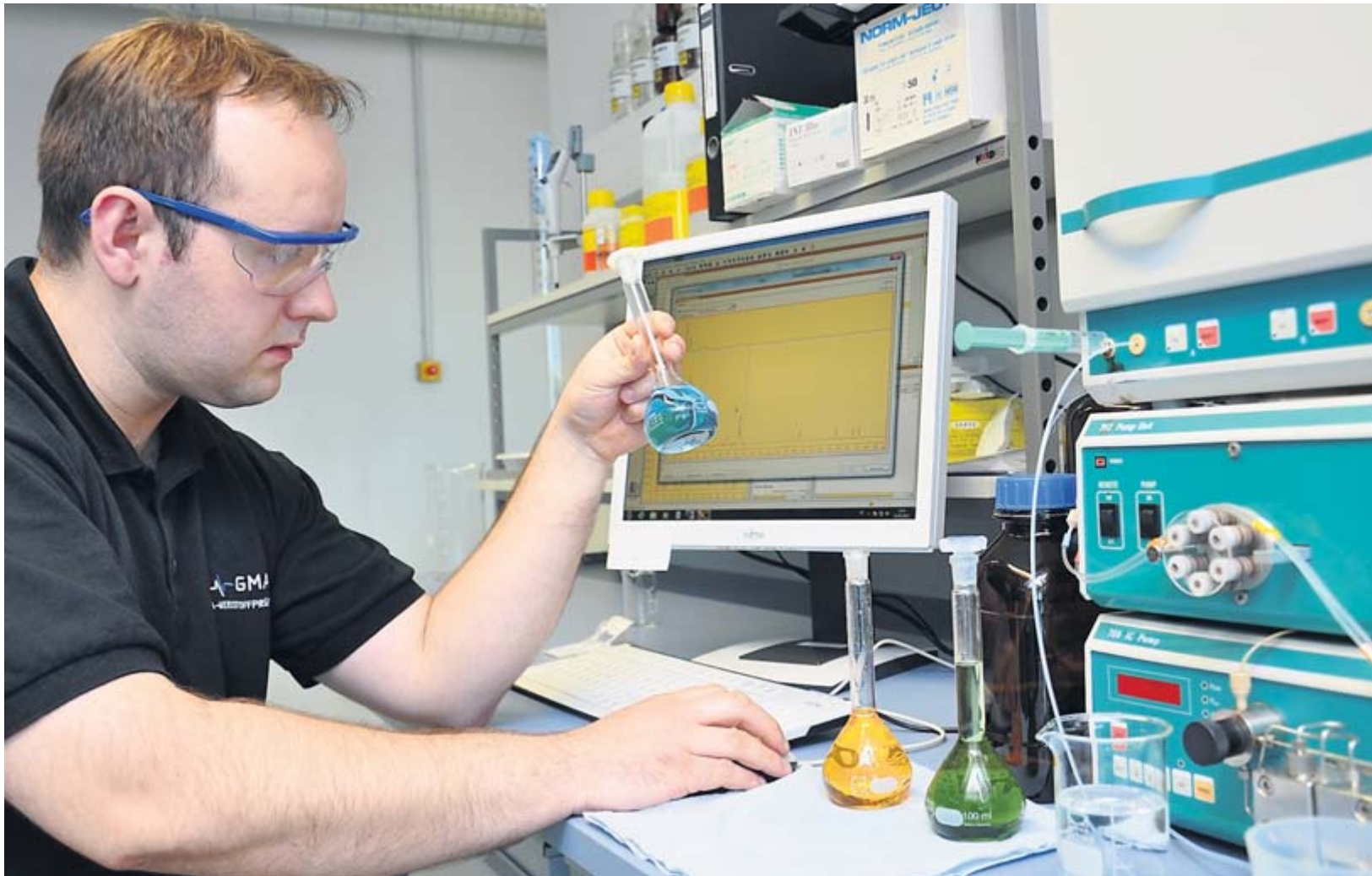
Chemielaborant Torsten Kuhlmann aus Schortens untersucht im GMA-Labor eine Abwasserprobe mit Hilfe eines Ionenchromatografen.
